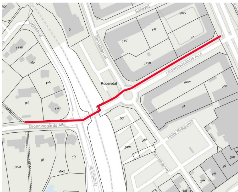
Kortudsnit med den aktuelle strækning af vejafvandsledningen markeret med rødt
