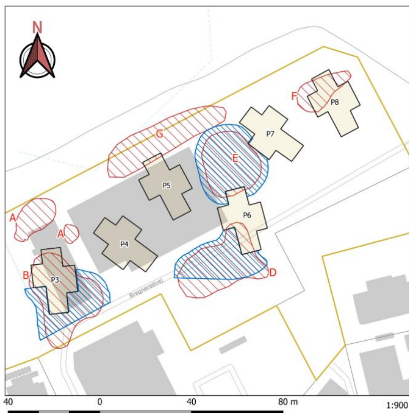
Figur 5. Oversigt over forurenede områder (A-F markeret med rød), og de steder, hvor der udlægges tætte bentonitmembraner for at undgå nedsvivning til grundvand.
