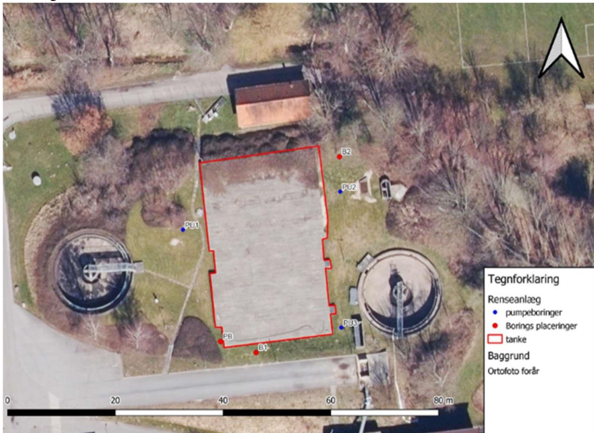
Figur 2 Pumpeboringerne placering ved tankene. Der er udført pumpeforsøg i borerne B1 og B2
