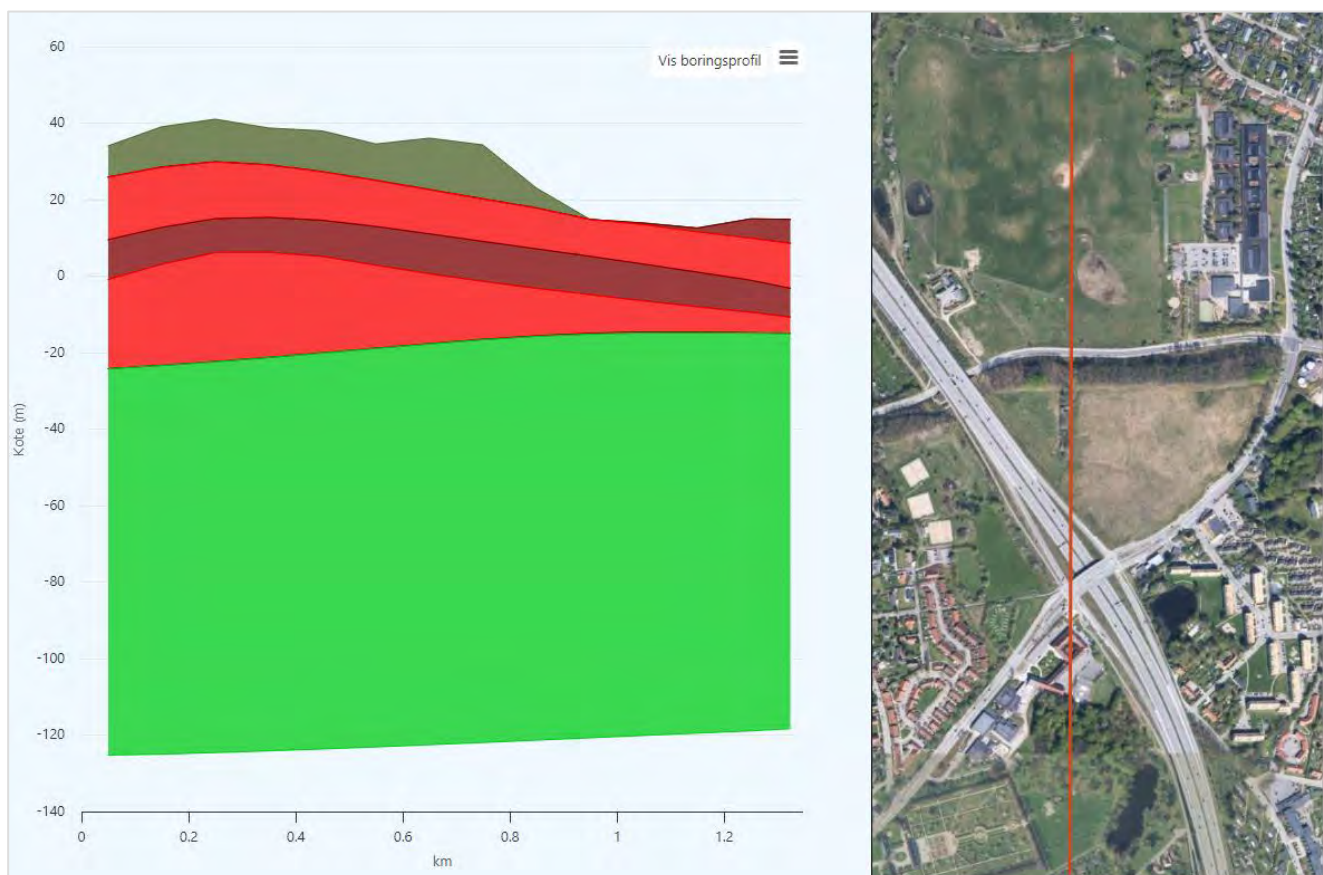
Figur 2: Tværsnit som viser de hydrostratigrafiske forhold i området. Data er fra FOHM-modellen.
