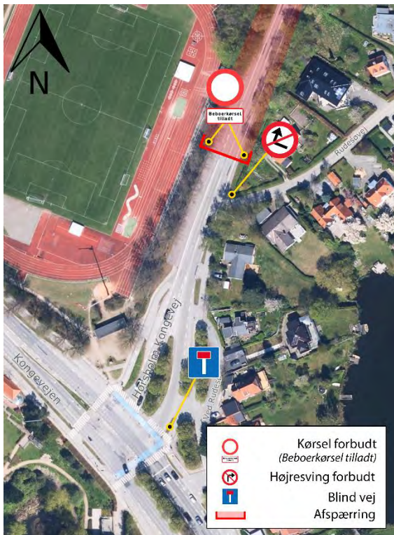
Figur 10 Lukning mod syd (etape 1)
