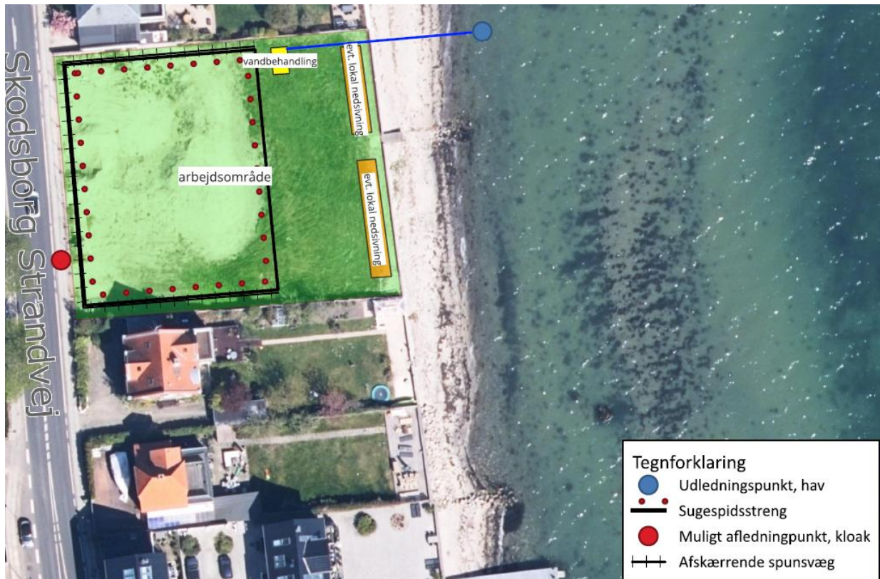
Figur 1 Skitse over oppumpning og udledning
