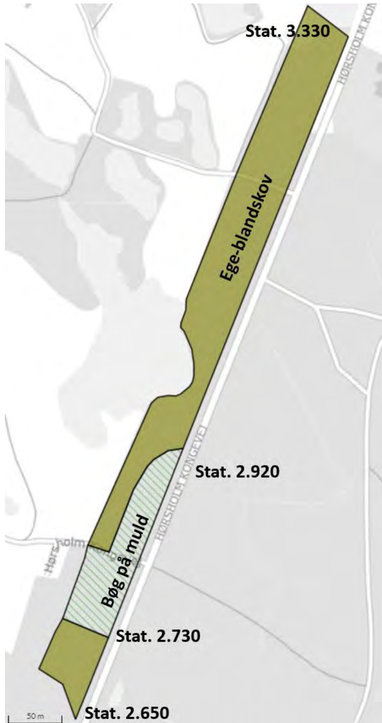
Figur 7-8. Kort over delstrækning, hvor projektområdet grænser op til areal med registrerede skovnaturtyper (hhv. 9130, bøg på muld og 9160 egeblandskov) fra station +2.650 til +3.330 meter.
