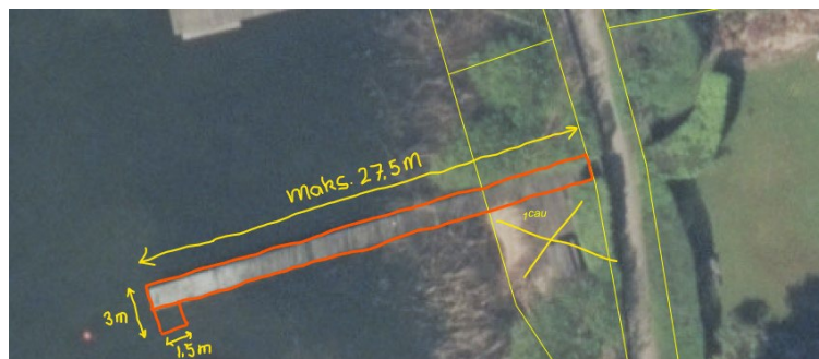
Figur 2. Skitsetegning med angivelse med rødt hvad der er meddelt tilladelse til. Broens dimensioner er angivet med gult. Bemærk at dispensationen indebærer, at platformen ved søbredden skal fjernes.
