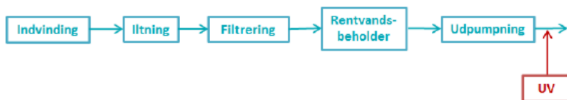
Figur 1: Placering af UV-anlæg i vandbehandlingsprocessen.
