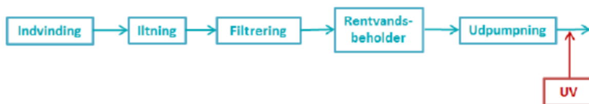
Figur 1: Placering af UV-anlæg i vandbehandlingsprocessen.
