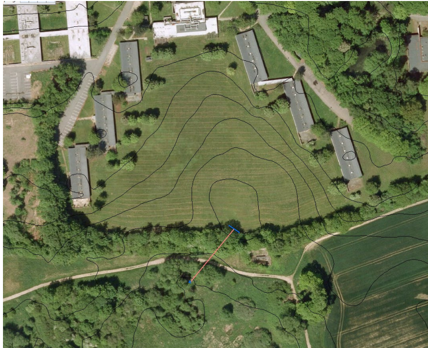
Figur 10. Oversigt fra området. Vandet fra 'Sletten' nedsives i filterkassen (den blå linje) og transporteres i drænrørret (den røde linje) til udledningspunktet i Maglemosen (det blå kryds).
