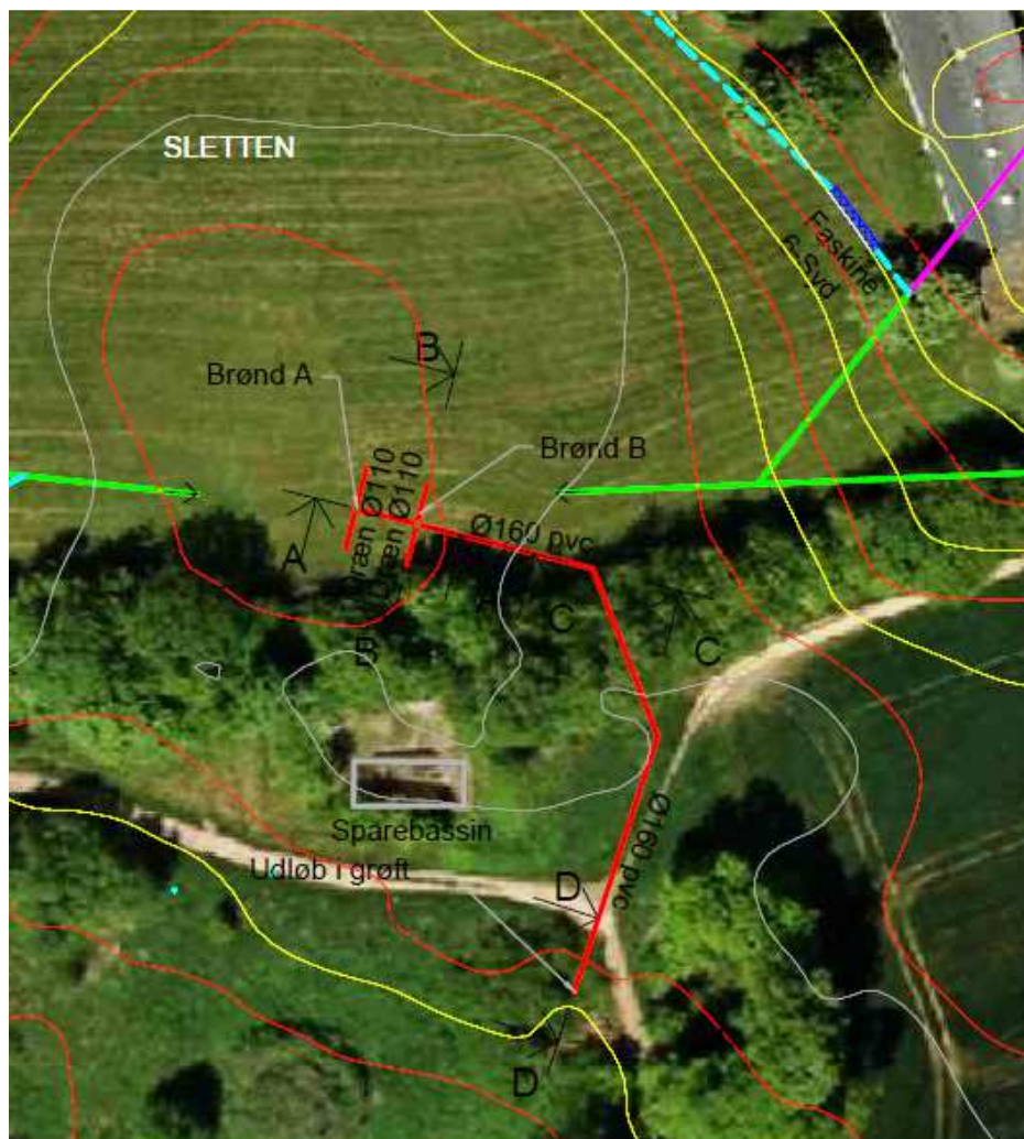
Figur 4. Placering af udledningspunkt (udsnit af tegningsbilag 1).
